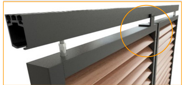
Escuadra tope para que el marco tenga un punto de apoyo al desplegar el folding y calzar el cierre del picaporte.
