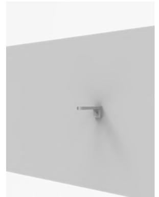
1. Primero se instalan en la parte superior del vano los soportes de anclajes al muro, esto se hace con un autoperforante #10 x 5/8" HWH.
